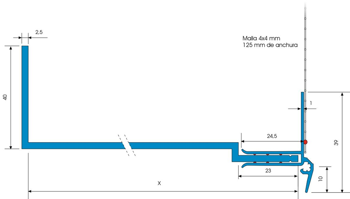
Dibujo seccional en mm
