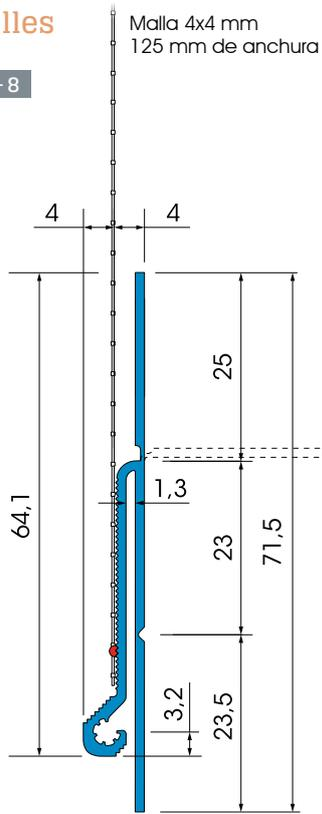
Dibujo seccional en mm
