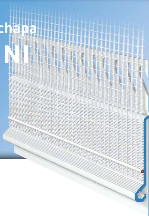
El **perfil de remate de chapa APU FIN-TEX MINI** se utiliza en sistemas compuestos de aislamiento térmico en conexiones de chapa (p. ej. acabado del borde del tejado) y gracias a su cámara hueca crea una conexión móvil y estanca entre el revoque y la chapa. El perfil se utiliza para un espesor de revoque de 8 mm y proporciona una conducción de agua dirigida una vez finalizados los trabajos de revoque.
