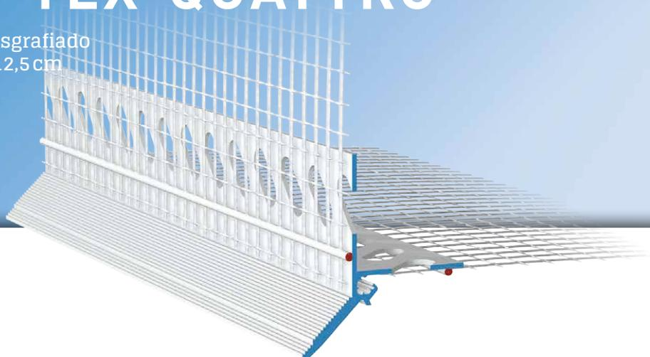
El **perfil de remate APU DROP-TEX-QUATTRO** se utiliza en sistemas compuestos de aislamiento térmico en horizontal para componentes de edificios con entrante como intradós de puertas y ventanas. El contorno de perfil oblicuo para esgrafiado ofrece una solución segura con respecto a la conducción de agua hacia abajo.
