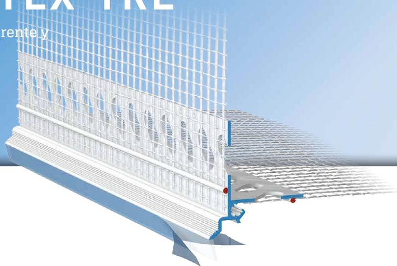
El **perfil de remate APU DROP-TEX-TRE** se utiliza en sistemas compuestos de aislamiento térmico en horizontal para componentes de edificios con entrante como intradós de puertas y ventanas. El contorno de perfil acodado con goterón transparente ofrece una solución segura con respecto a la conducción de agua hacia abajo.
