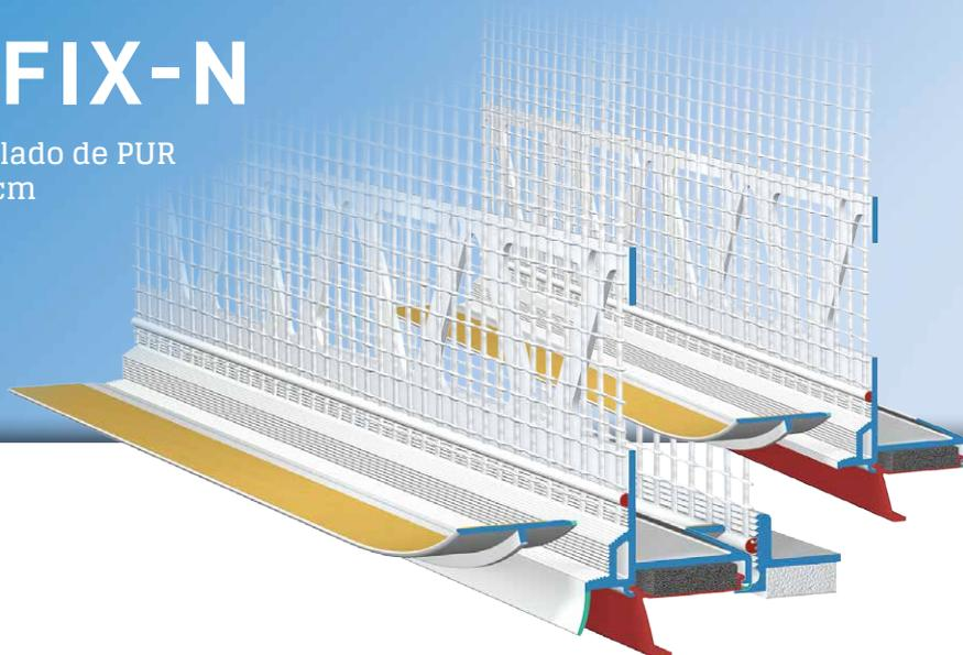
El **perfil de remate con malla APU PUR-FIX-N** se utiliza en sistemas compuestos de aislamiento térmico conforme a los criterios de selección actuales de APU. El perfil se fija en el aislante una vez abierta la lengüeta de activación roja en el aislamiento del intradós a una distancia de aprox. 2 mm del componente con los clavos de plástico incluidos (Z21) y ofrece una conexión de revoque segura y limpia una vez finalizados los trabajos de revoque.
