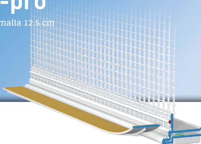
El **perfil de remate con malla TORINO-pro** se utiliza en sistemas compuestos de aislamiento térmico conforme a los criterios de selección actuales de APU. El perfil se pega enrasado en el intradós sobre el componente existente y ofrece una conexión de revoque segura y limpia con junta de sombra una vez finalizados los trabajos de revoque.
