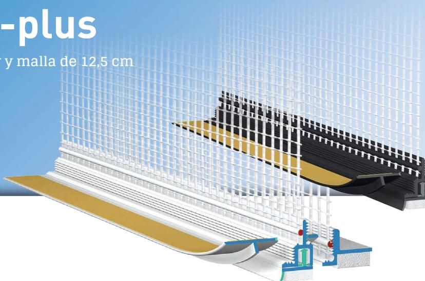
El **perfil de remate con malla telescópico IDEAL-plus** se utiliza en sistemas compuestos de aislamiento térmico conforme a los criterios de selección actuales de APU. El perfil se pega enrasado delante del aislamiento del intradós sobre el componente existente y ofrece una conexión de revoque segura y limpia una vez finalizados los trabajos de revoque.
