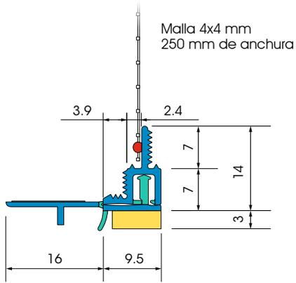
Dibujo seccional en mm
