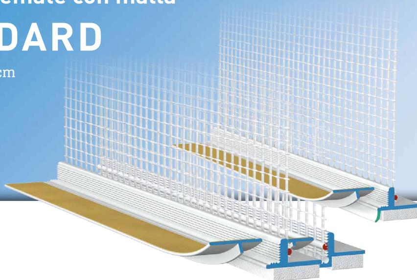
El **perfil de remate con malla STANDARD** se utiliza en sistemas compuestos de aislamiento térmico conforme al ámbito de aplicación de APU. El perfil se pega enrasado en el intradós sobre el componente existente y forma de este modo una conexión de revoque limpia y segura.
