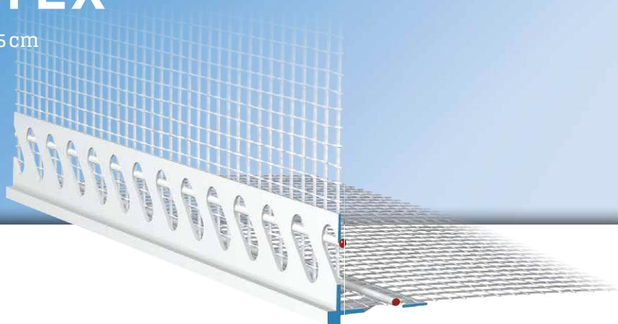
La **malla esquinera APU DECO-TEX** se utiliza en sistemas compuestos de aislamiento térmico como borde enrasado y resistente a los golpes para revocos finales de capa fina.
