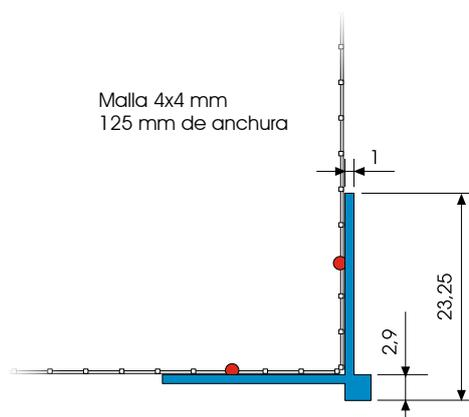
Dibujo seccional en mm
