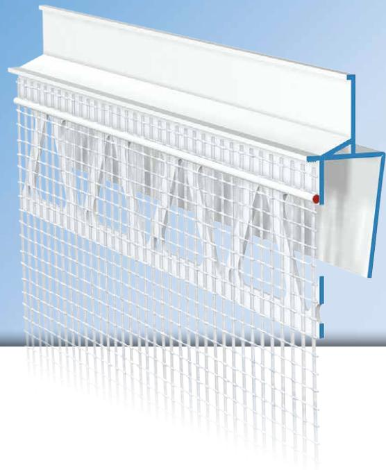
El perfil de juntas **APU VHF-PRO-TEX** se utiliza en fachadas ventiladas como remate sobre el borde del panel portante. En conexión con el perfil de juntas VHF-DROP-TEX (V82) se forma de este modo la junta de partición en horizontal y vertical y se crea un borde del revoque limpio con junta de sombra.
